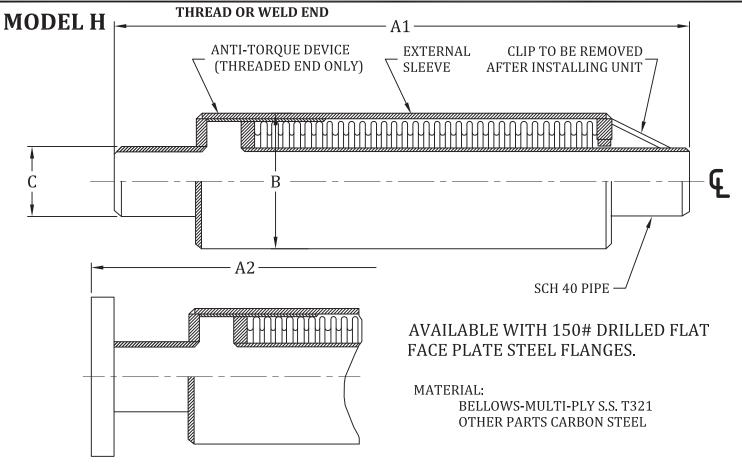
THE EXPANSION JOINT IS DESIGNED FOR AXIAL MOVEMENT ONLY.
